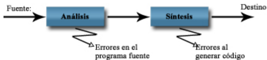
Figura 2.4: Esquema por etapas de un traductor
