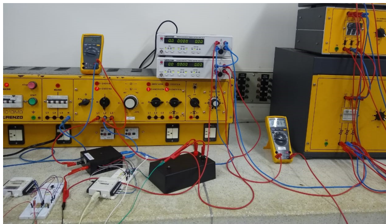
Figura 11: Montaje para mediciones de la guía transformada de park
