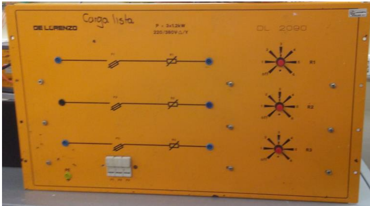
Figura 13. Vista frontal del módulo de carga DL 2090. Los selectores han sido cambiados por los pulsadores.
