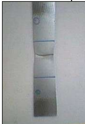
Figura 4.1. Fotografía de la probeta sin muesca después del ensayo de tracción. Nótese el área de sección reducida en la parte central de la probeta.
