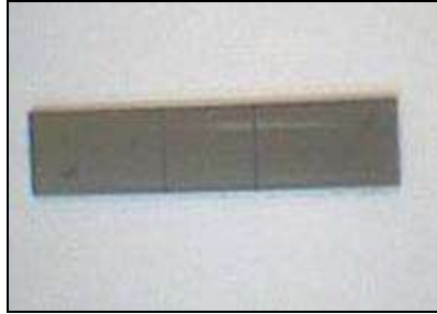
Figura 3.1. Fotografía de la probeta sin muesca empleada para el ensayo de tracción.
