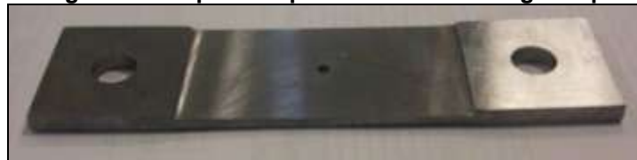
Figura 3.5. Fotografía de la probeta para crecimiento de grieta por fatiga axial.
