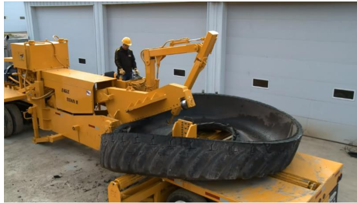
Ilustración 3.3.2-3 Eagle Punch Cutter en funcionamiento. Fuente: Eagle International, 2014
