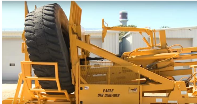
Ilustración 3.3.2-1 Eagle Debeader extracción del material. Fuente: Eagle International, 2014
