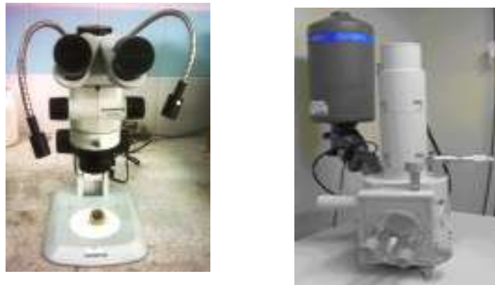
Figura 18 A la derecha, microscopio electrónico de barrido. A la izquierda, estéreo microscopio.
