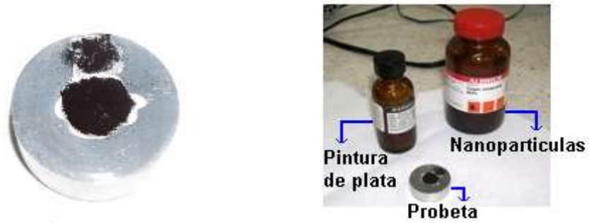
Figura 17 Preparación de probeta para observación en el microscopio electrónico de barrido.
