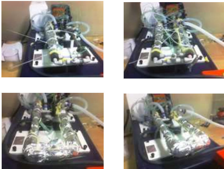
Figura 14 Aislamiento térmico con lana de vidrio del intercambiador de calor de tubos concéntricos
