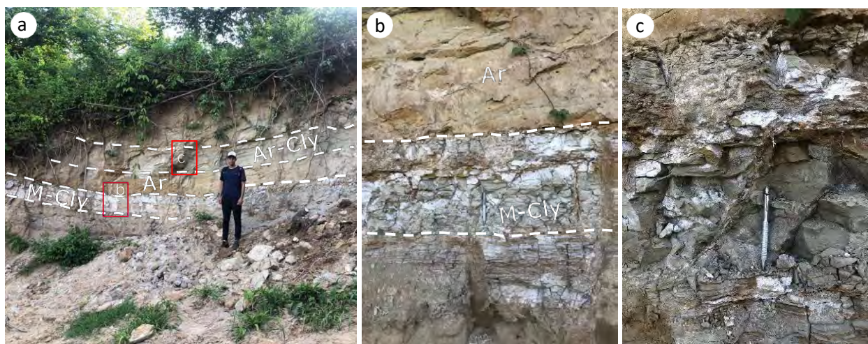
Figura 13. Imágenes identificación de litologías asociadas para ‘TB’. a) Secuencia litológica de afloramiento. b) y c) diferentes muestras tomadas en distintos puntos del afloramiento para homogenizar. Ar: arenisca; M-Cly: arcilla meteorizada.
