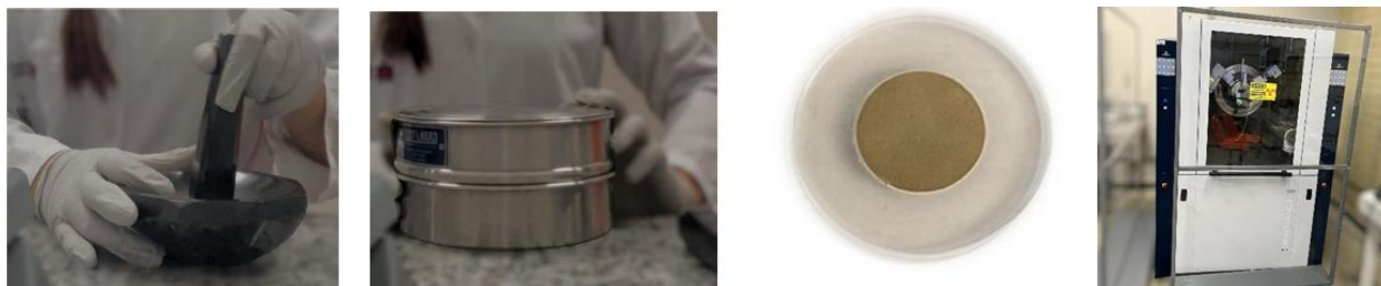
Figura 8. Preparación de muestras y montaje instrumental para el análisis por difracción de rayos X (DRX). Fuente: Elaborado por Rodríguez (2025).
