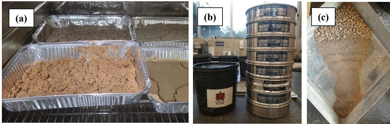
Figura 7. Preparación de sedimentos para análisis granulométrico: (a) secado en horno a 110 °C, (b) tamizado en columna de mallas y (c) fraccionamiento resultante post-tamizado.
