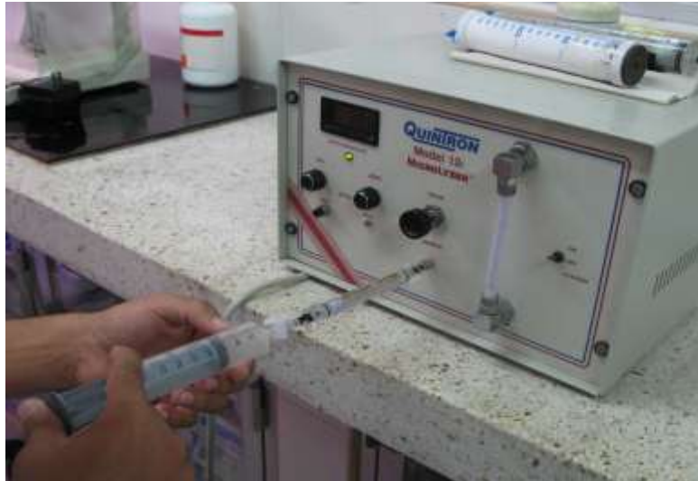
Fotografía 3. Inyección de la muestra en el cromatógrafo de gases Microlyzer de Quintron®
